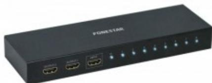
1 x 8 splitter HDMI (1 ingresso x 8 uscite). Risoluzione UHD 4K@30Hz. HDMI 1.4. HDCP 1.4. Larghezza di banda 10,2 Gbps. Consente di amplificare e distribuire il segnale HDMI senza perdite su 8 display contemporaneamente. La funzione EDID seleziona automaticamente la risoluzione ottimale per tutti i televisori. È un dispositivo Plug and Play (non è necessaria alcuna configurazione precedente). Ideale per l'uso in scuole, impianti sportivi, sale conferenze, home theater, ecc.
