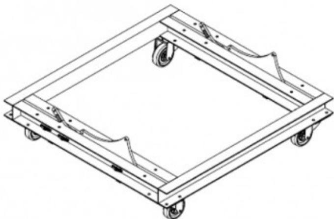
PL-12S è un carrello in acciaio che permette di impilare e trasportare fino a 6 unità di
