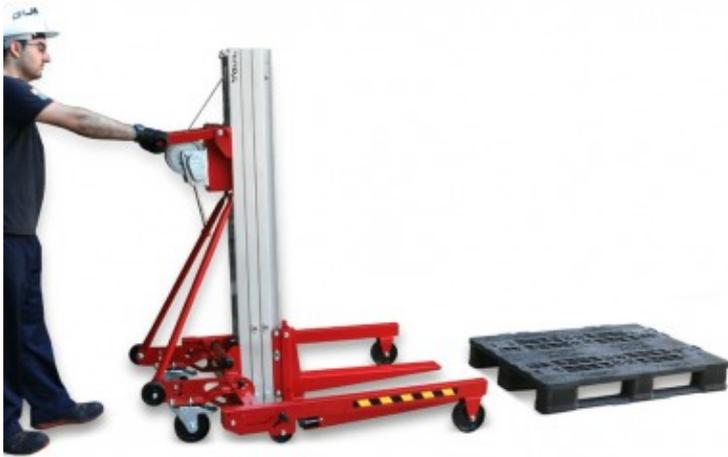
Sollevatore di materiale realizzato in alluminio e acciaio, progettato per sollevare carichi fino a 200 kg fino ad un'altezza massima di 3,45 metri.
