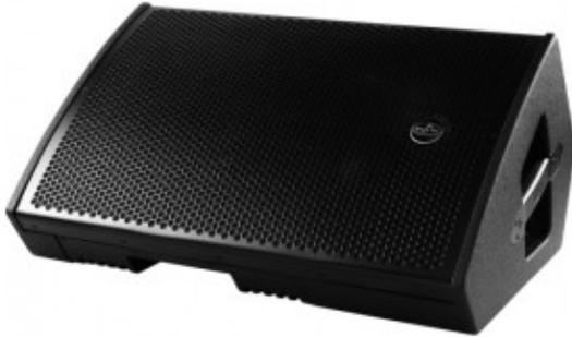
Il ROAD-15ALT-230 è un monitor da scenario auto-amplificato dotato di un altoparlante 15R4 per la riproduzione di basse frequenze. Per le alte frequenze, si usa un motore a compressione M-75 con geometria di uscita da 1,5" e un diaframma al titanio da 3".
