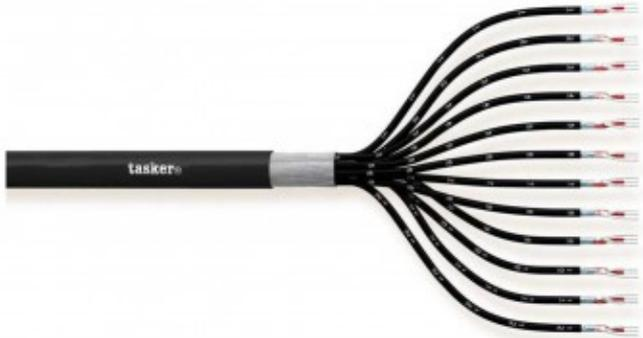
Cavo multicoppia audio digitale 110 Ohm AES/EBU - 24x2x0,14 mm<sup>2</sup>
