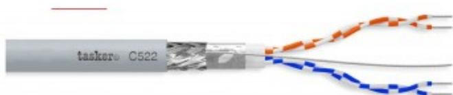
Grigio PVC morbido ignifugo. Cavo esterno Diam. Ø 8,60 (±0,10) mm. Prima schermatura in treccia di rame stagnato O.F.C., copertura 85%.
