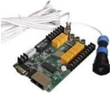
Monitoraggio della luminosità ambientale, che consente la regolazione automatica della luminosità del display LED
