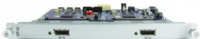
Scheda di ingresso DisplayPort, supporta ingresso segnale DVI a 2 canali, supporta lo standard DP 1.1, la risoluzione di ingresso è tipica 3840x2400 a 30 o 2560x1600 a 60, supporta la modifica online EDID, supporta il segnale di ingresso senza elaborazione della perdita di frame
