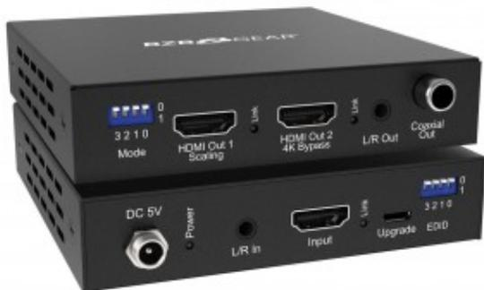
BG-UHD-SC1X2 è uno splitter HDMI 4K 18Gbps con scaler integrato, specificamente progettato per installazioni che richiedono la distribuzione di una singola sorgente video 4K su più display con limiti di risoluzione video.
