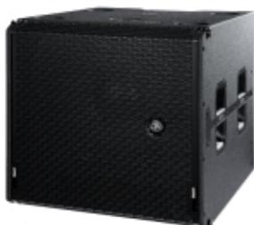
Subwoofer alimentato a cardioide. Driver frontale al neodimio da 18" con bobina mobile da 4". Trasduttore in configurazione cardioide da 15" e bobina mobile da 3". Amplificatore a 4 canali, Classe D, 3000 Wrms
