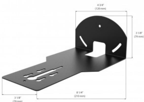
BG-VPTZ-WM è una staffa per montaggio a parete per la serie di telecamere VPTZ. Ritagli multipli consentono opzioni versatili di montaggio e passaggio cavi. Questa staffa è realizzata in resistente acciaio di grosso calibro con finitura verniciata a polvere ed è progettata per fornire una base sicura e stabile per la tua telecamera PTZ. Può essere montato direttamente su cartongesso, legno o muratura.
