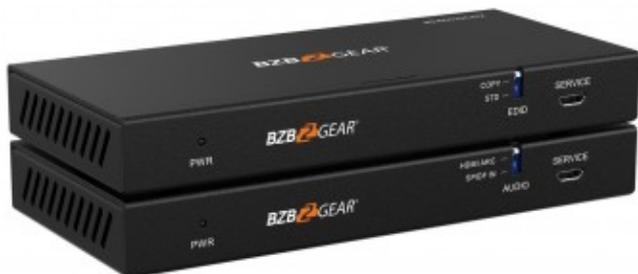
BG-EXH-70C4, la soluzione definitiva per estendere i segnali HDMI su una lunga distanza fino a 70 m / 230 piedi. Questo extender è un dispositivo altamente efficiente che converte il segnale HDMI in HDBaseT standard e lo trasmette tramite un singolo cavo Ethernet CAT5e/6.
