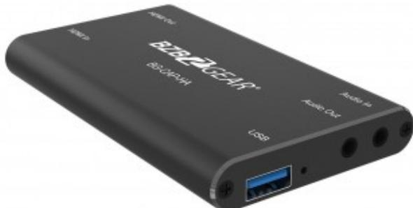
BG-CAP-HA è un dispositivo di acquisizione 4K progettato per convertire una sorgente HDMI in un'uscita USB 3.0 per la registrazione, l'editing e/o lo streaming da un PC o Mac. Questa unità riceve audio e video a risoluzioni fino a 4K@60Hz 4:4:4 HDR10 con una risoluzione di uscita di 1080P@60Hz.
