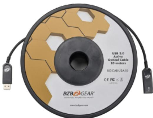
Il BG-CAB-U3A è un cavo di prolunga ottico attivo da USB 3.0 tipo A maschio a tipo A femmina ed è disponibile in varie lunghezze da 15 m a 50 m. Questo cavo converte il segnale dati USB in segnale ottico su fibra e supporta velocità di larghezza di banda fino a 5 Gbps. È dotato di schermatura completa per trasmissioni di dati senza errori, protezione da sovracorrente e supporta la funzionalità UASP con host Windows 11, 10, 8 e USB 3.0.
