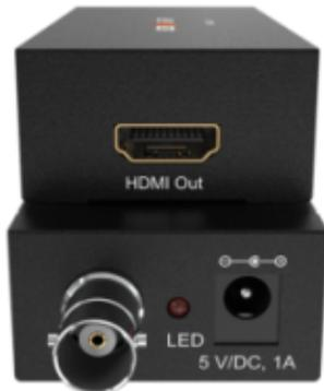
Il BG-3GSH è un convertitore di segnale versatile progettato per convertire i segnali SD-SDI, HD-SDI e 3G-SDI nell'interfaccia HDMI più comunemente utilizzata. Con un bit rate elevato di 2.970 Gbit/s, l'unità supporta la trasmissione di segnali video senza alcuna perdita, garantendo un'immagine cristallina a 1080p@60 sui display HDMI. Il BG-3GSH supporta anche gli standard SMPTE 425M, SMPTE 424M, SMPTE 292M e SMPTE 259M-C, rendendolo compatibile con un'ampia gamma di sorgenti video.
