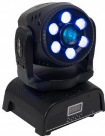
Testa mobile a LED Spot Wash DMX 2 in 1. 6 LED RGBW + 1 LED LUCE BIANCA. Automatico, attivazione sonora, controllo DMX e modalità master/slave. 13 o 18 canali DMX.
