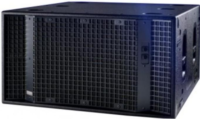
L'ES-218 è un sistema subwoofer bass-reflex che utilizza due trasduttori 18UXN di nuova concezione. Gli altoparlanti incorporano caratteristiche all'avanguardia come una bobina mobile con avvolgimento diviso a sandwich da 4", una notevole escursione da picco a picco di 52 mm e un potente gruppo di magneti al neodimio ottimizzato FEA (Finite Element Analysis).
