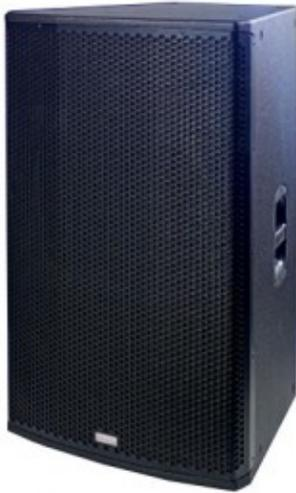
L'ES-158 è un sistema di sorgenti puntiformi a gamma completa a 3 vie, progettato per fornire una potente soluzione autonoma. Un basso da 15" caricato a tromba e un midrange da 8", in un dispositivo di caricamento a proiettile, gestiscono le frequenze medio-basse. Il driver a compressione al neodimio M-75N fornisce un'eccezionale riproduzione ad alta frequenza. L'ES-158 può essere utilizzato sia in posizione verticale che orizzontale grazie al suo gruppo di corno medio alto girevole.
