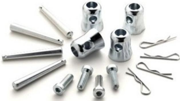
Kit di connessione formato da 4 mezzi spigot, 4 viti, 4 coppie e 4 spine per la connessione di truss ai moduli con dado.
